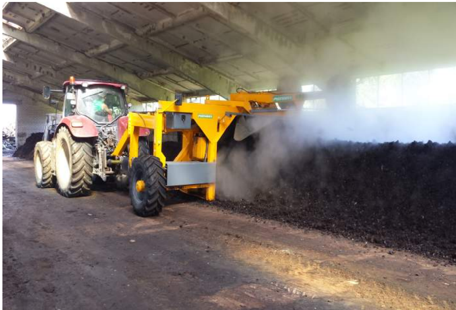
3 pav. Komposto rietuvių vartymas prikabinamu vartytuvu MENART 4800 SP
