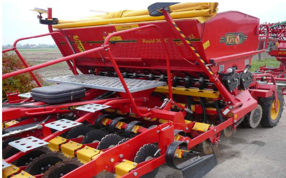
9 pav. Sėjamoji VÄDERSTAD Rapid 300 C Super XL su lokalaus trąšų įterpimo agregatu
